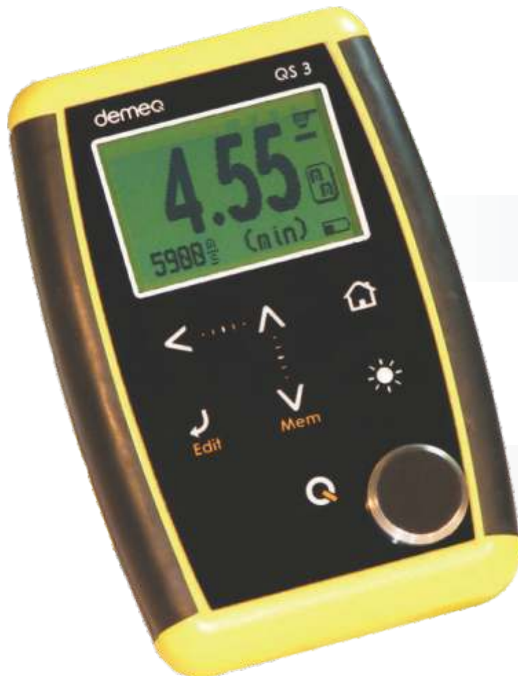
Pantalla de medición: Dígitos grandes, Valor Min., Unidad, Indicador de batería
