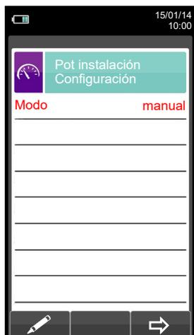
Introducir la potencia térmica calculada manualmente por el usuario.
