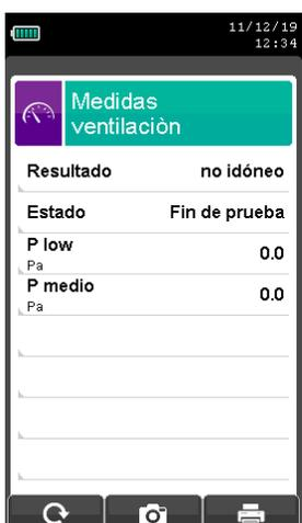
UNA VEZ FINALIZADAS LAS 3 MEDICIONES, LA PANTALLA MUESTRA EL VALOR MEDIO Y EL RESULTADO DE LA PRUEBA.
