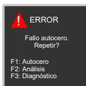
Este mensaje de error se muestra si el autocero del instrumento no se ha podido llevar a cabo.
