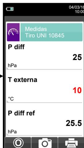
Ventana en caso de utilizarse un depirómetro externo:
