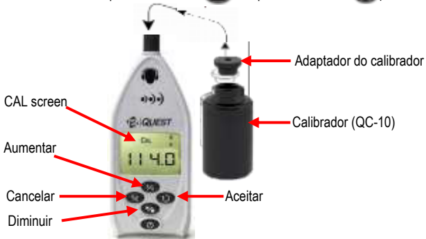
Figura 1-10: Calibração do SD-200
