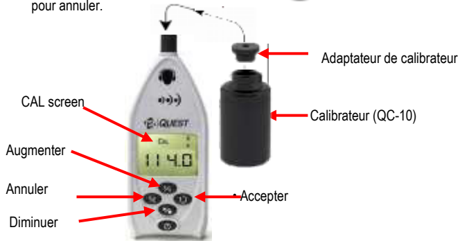
Figure 1-10 : Étalonnage du SD-200
