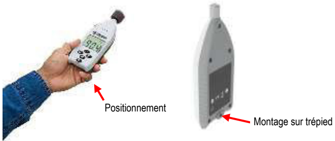
Figure 1-9 : Positionnement et montage sur trépied
